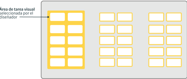
Figura 3.2.2.2. a. Ejemplo de selección del área de tarea visual para el diseño de iluminación. (Fuente propia)
